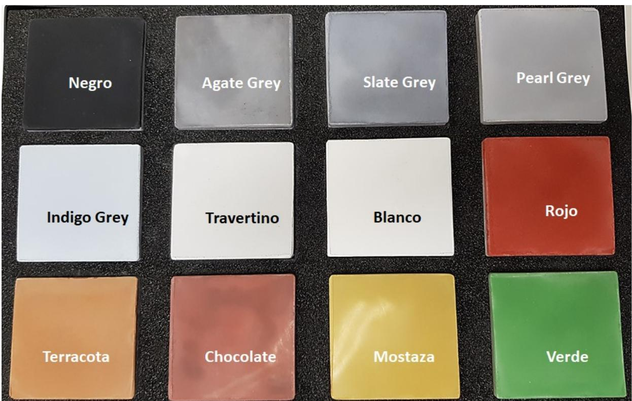
**Nota:** Esta carta de colores es orientativa y está referida al color de la propia capa de rodadura amasada con agua y sin mezclar con cualquier tipo de hormigón que le rebajará en diferente medida según los componentes de este(cemento, agregados y arenas y aditivos), siendo necesario el ensayo de tonalidad final sobre el soporte escogido en condiciones reales de obra para obtener una aproximación al acabado final. Consulte siempre a nuestro Departamento Técnico-Comercial.
